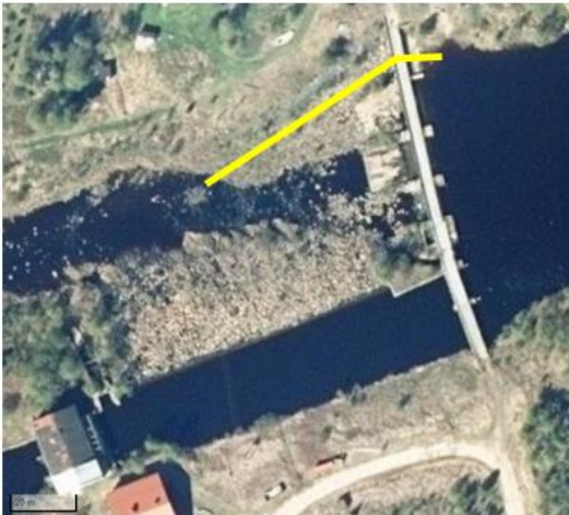
Keltaisella viivalla noin 85 m pitkä luonnonpuomainen kalatie. (Karttapohja MML avoin tietokanta, 15.9.2019, kuva H. Alatalo)
